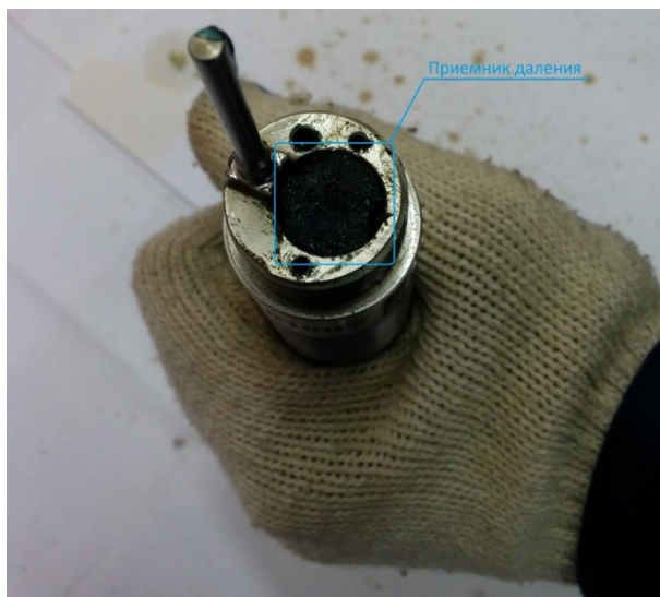
Рис.6 Вид приемника давления заполненного смазкой при снятой заглушке
